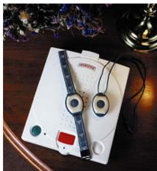
Figura 9. Terminal y pulsadores teleasistencia (derecha); detector de caídas (izquierda). Fuente: Attendo.
