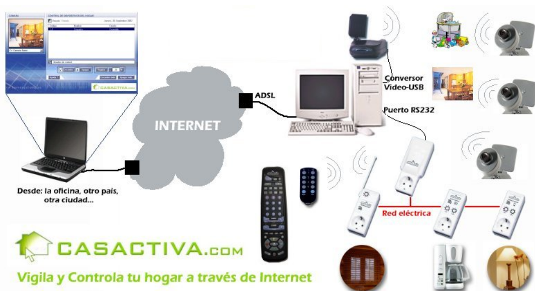
Figura 10. Instalación basada en X10. Fuente: Casactiva.com.
