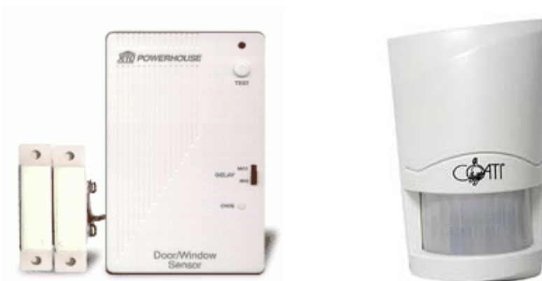
Figura 7. Sensor puerta/ventana (izquierda); sensor de movimiento por IR (derecha). Fuente: domotica.net y mundogar.com.
